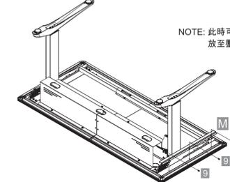
依照圖示，固定壓線槽。
