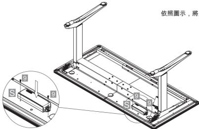
依照圖示，將馬達控制器鎖固在桌板。
